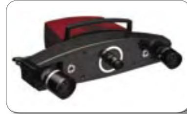
CON BASE EN UN PRINCIPIO DE TRIANGULACIÓN, ESTE DIGITALIZADOR USA UN ARREGLO REDUNDANTE DE INFORMACIÓN A PARTIR DE DOS CÁMARAS DE VIDEO; EN ESTE ARREGLO LAS CÁMARAS (A LOS EXTREMOS) Y LA UNIDAD DE PROYECCIÓN (EN LA PARTE CENTRAL) SE INTEGRAN EN EL CABEZAL DEL SENSOR.
